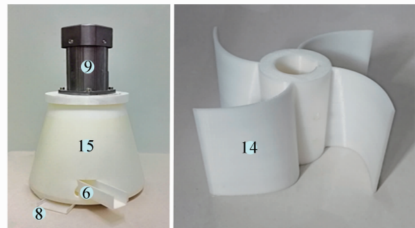
6. 出料导槽; 8. 沥水导槽; 14. 搅动叶片; 15. 沥水外桶
