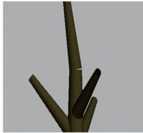
图2 圆台段元拼接处缺口
