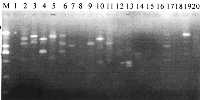
图 2 2 号香果树 DNA 用随机引物 BA0001~BA0020 扩增产物电泳图 (M. 100 bp ladder)
