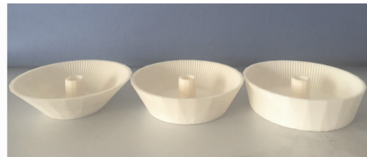
图 3 不同斜角(45°, 60°, 75°)的 3 个雾化转盘
