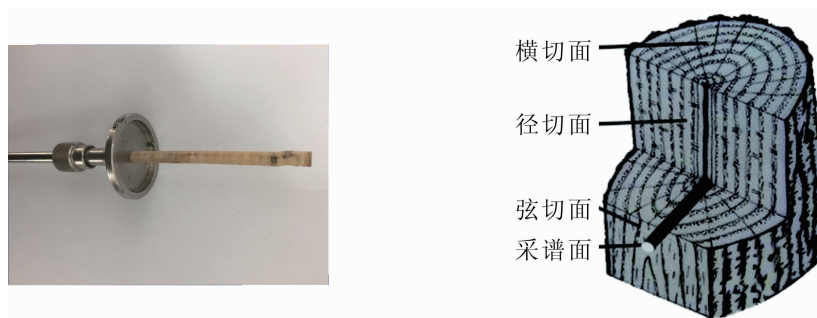
图 1 生长锥样品光谱采集方法
