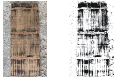
图 2 图像处理前后展平竹板材试样表面
