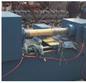
图 1 车削去青机及去青车刀
