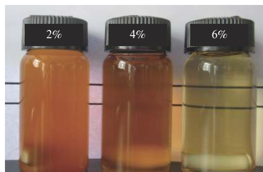
图 5 不同 LiCl 质量分数溶剂体系中稻草秆(球磨 1.0 h)的溶解性能
