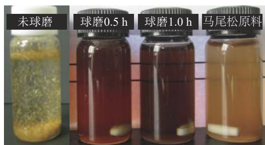
图 2 稻草叶不同球磨时间下的溶解性能 (质量分数为 6% LiCl/DMSO)
