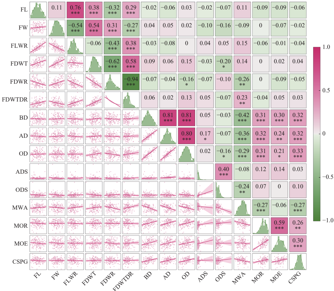
FL. 纤维长度；FW. 纤维宽度；FLWR. 纤维长宽比；FDWT. 纤维双壁厚；FDWR. 纤维腔径比；FDWTDR. 纤维壁腔比；BD. 基本密度；AD. 气干密度；OD. 绝干密度；ADS. 气干差异干缩；ODS. 全干差异干缩；MWA. 最大吸水率；MOR. 弯曲强度；MOE. 弯曲模量；CSPG. 顺纹抗压强度。*、**、***分别表示在0.05、0.01、0.001水平上相关显著。
